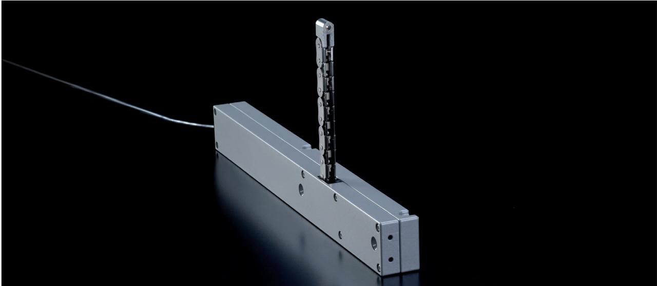
Durch seine schlanke Bauform ist der LM in vielen Fällen verdeckt montierbar. Da kein Schwenkbereich benötigt wird, ist die Montage auch in beengten Verhältnissen möglich. Durch vielseitige Befestigungsmöglichkeiten ist der Antrieb mit Druck-/Zugkräften bis 200 N variabel einsetzbar. Erhältlich als LM/2 oder als LM/EasyDrive/2.
