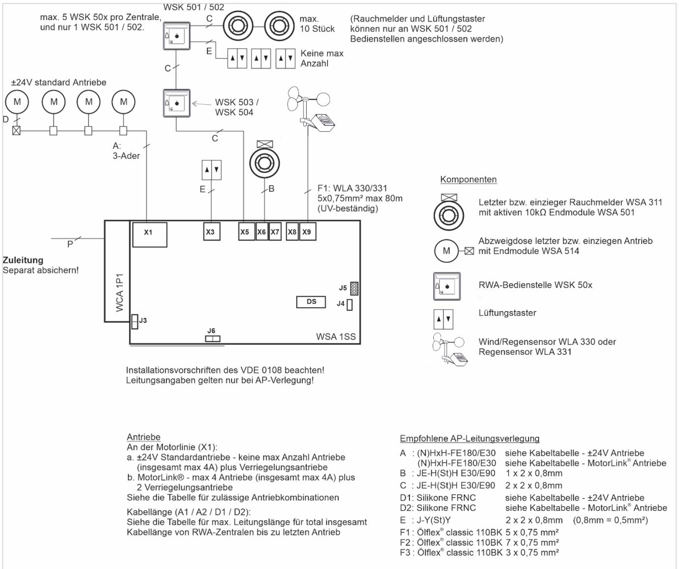
Der Plan oben zeigt die WSC 104 mit angeschlossenen ±24V Standardantrieben.
