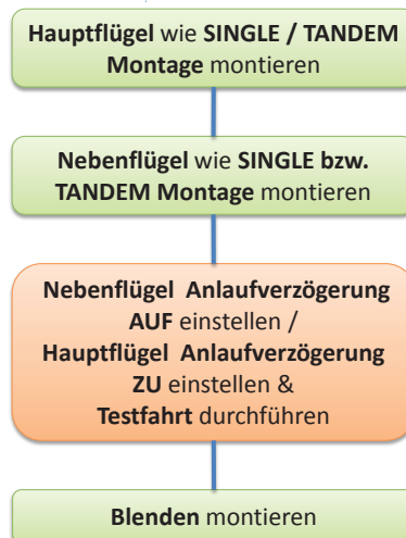
Abbildung 9: Montagereihenfolge STULPFLÜGEL Montage
