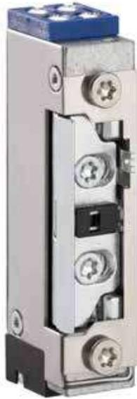
Der Vektortüröffner A4021 überzeugt durch seine kleinen Maße und das fast lautlose Öffnungsverhalten bei Gleichstrom auch unter hoher Vorlast. Zusätzlich besitzt er einen Schaltkontakt (Rückmeldung), welcher von der Schlossfalle betätigt wird. Durch einen 2 mm längeren Entriegelungshebel kann der Türöffner mechanisch dauerentriegelt werden.
