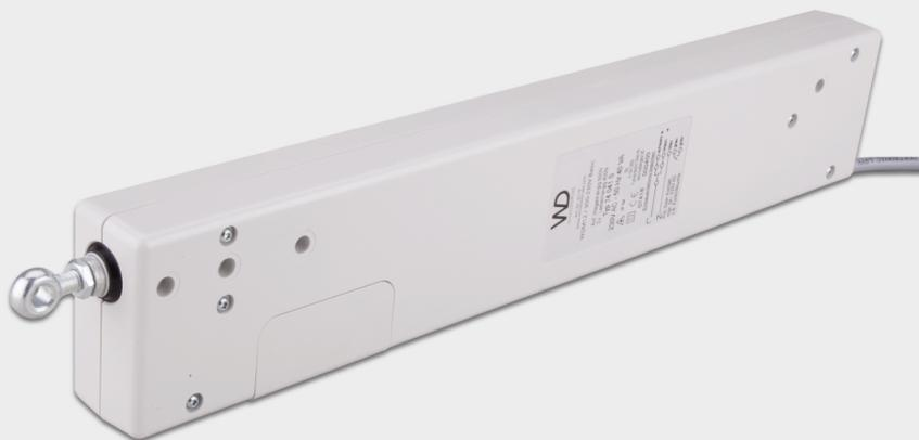
**Kurzbeschreibung:** Hochwertiger Spindeltrieb im Kunststoffgehäuse zum Öffnen von Lichtkuppeln und Dachfenstern. In den Endlagen schaltet der Antrieb automatisch ab. Mehrere Antriebe können ohne weiteres Zubehör parallel geschaltet werden. Der optional anschließbare potentialfreie Meldekontakt ist dann geöffnet, wenn der Antrieb vollständig eingefahren ist.
