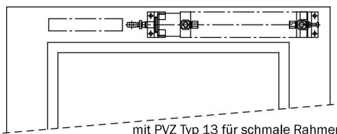
Je zwei Stirnböckchen werden zur starren Befestigung eines Zylinders, z. B. auf einer Fensterbank, benötigt. Somit lassen sich u. a. Scherenbeschläge betätigen.
