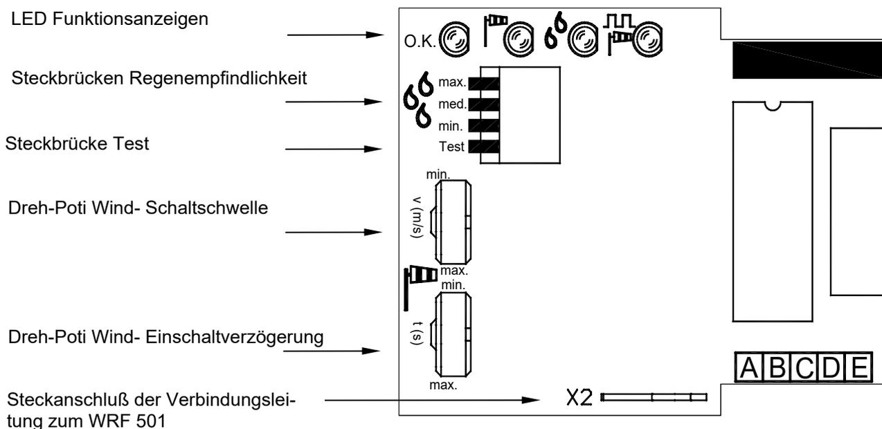
Abbildung 4: Ansicht des WR-MOD 501 ( Wind-/Regen- Modul )
