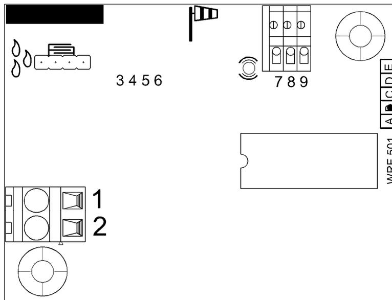
Abbildung 2: Ansicht des WRF 501 ( Wind-/Regen- Fühlerplatine )
