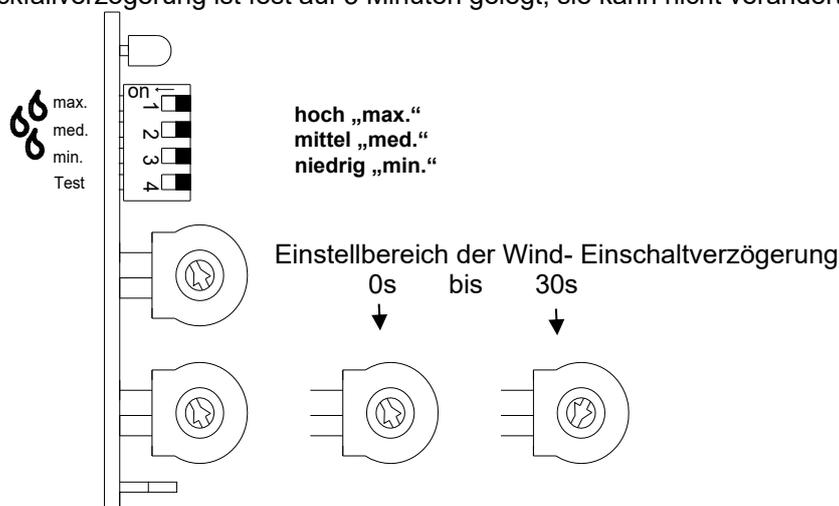
Abbildung 5: Ansicht des WR-MOD 501 Einschaltverzögerungszeit
