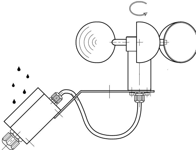
Abbildung 3: Ansicht des WRF 501 ( Wind-/Regen- Fühler )
