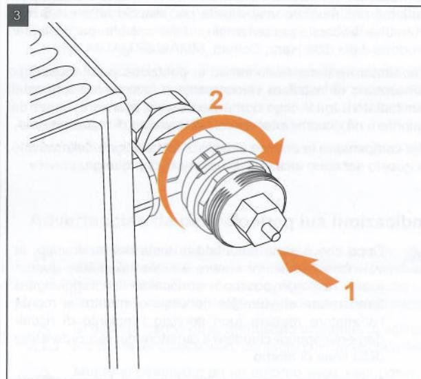
**Montar el nuevo termostato de radiador //**
