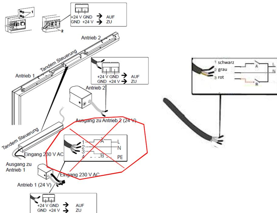
Schwarzes Kabel 1 (Phase  $L_{zu}$ ) an den Anschluss des gebäudeseitigen ZU-Taster anklemmen, rotes Kabel 3 (Phase  $L_{auf}$ ) an den Anschluss des gebäudeseitigen AUF-Taster anklemmen und graues Kabel (Null N) an den gebäudeseitigen Null-Leiter anklemmen. Bewegungsfreiheit für einen Test schaffen, Funktion kurz testen und gebäudeseitigen Schalter/Abzweigdose schließen.
