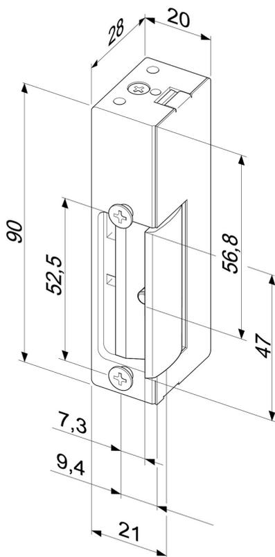
Max. Fallenvorlast DC (stabilisiert) 10 N
