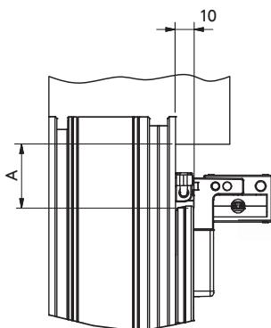
A = 24 mm bis 34 mm bei schwenkbarer Flügelmontage je nach Öffnungswinkel
