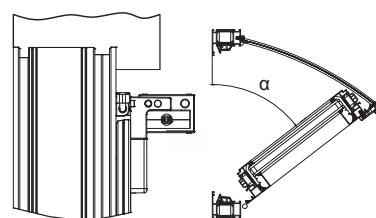
Schwenkbare Flügelmontage mit FLR/CDs Konsolen
