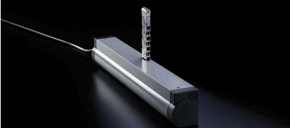
Der FM 309-401 besitzt eine Doppelkette, die sich wie bei einem Reißverschluss zusammenfügt und verzahnt. Dadurch besitzen die Antriebe eine sehr hohe mechanische Stabilität bei flachem Kettenaufbau. Damit lassen sich auch Öffnungselemente mit einem geringen Blendrahmenfreimaß motorisch betätigen. Durch seinen kräftigen und geräuscharmen Antrieb sowie seine besondere Form ist er gut für Anwendungen mit höheren Komfortanforderungen geeignet, z. B. auch in Wintergärten.
