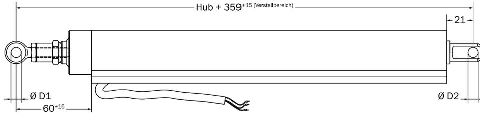
**Bestellbezeichnung:** JM-DC-B-SYN - Last - Hub (- Strom) - M 8 / Ø D 1 (oben) M 8 / Ø D 2 (unten)
