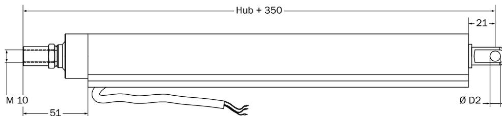
**Bestellbezeichnung:** JM-DC-B-SYN - Last - Hub (- Strom) - M 10 GK Ø D 1 (oben) Ø D 2 (unten)
