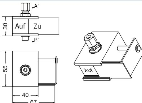
**SSi 25 für Rohreinbau**
