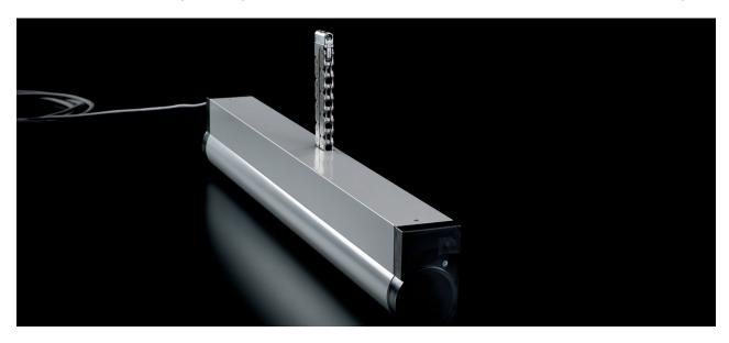
Der FM 501-800 besitzt eine Doppelkette, die sich wie bei einem Reißverschluss zusammenfügt und verzahnt. Dadurch ergibt sich im ausgefahrenen Zustand der Kette eine hohe Stabilität zu allen Seiten, trotzdem ist die Kette flexibel und erlaubt in vielen Fällen eine feste Montage des Antriebs ohne weitere Schwenkkonsolen. Der Dichtschluss des Antriebs ist mechanisch einstellbar. Durch seinen geräuscharmen Lauf ist er auch für den Einsatz in akustisch sensiblen Umgebungen geeignet.
