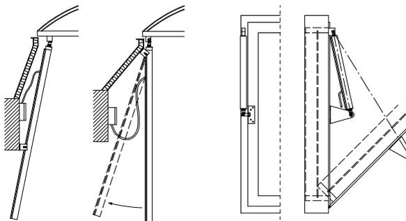
Montage des JM-DC mit Konsole KB 5 und Flügelböckchen an einer Lichtkuppel
