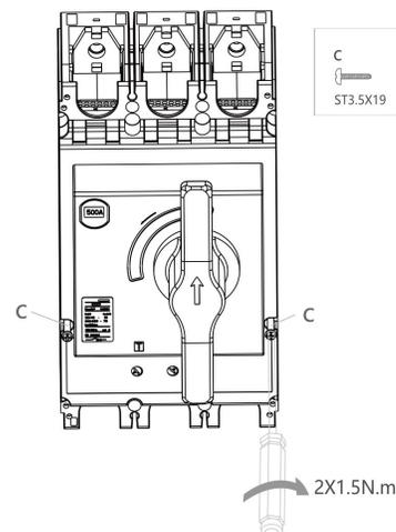
Das Typenschild wird zusammen mit dem Leistungsschalter geliefert, Sie müssen es selbst einfügen.
