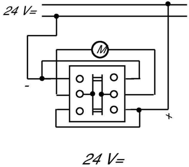
Ansteuerung eines Gleichspannungsantriebes über 2-poligen Jalousieschalter /-taster (Polwendung) 2712 U /2722 U
