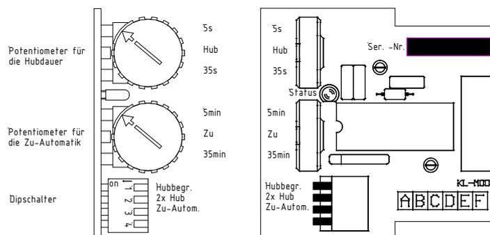
Abbildung 9: Komfort- Lüftungsmodul
