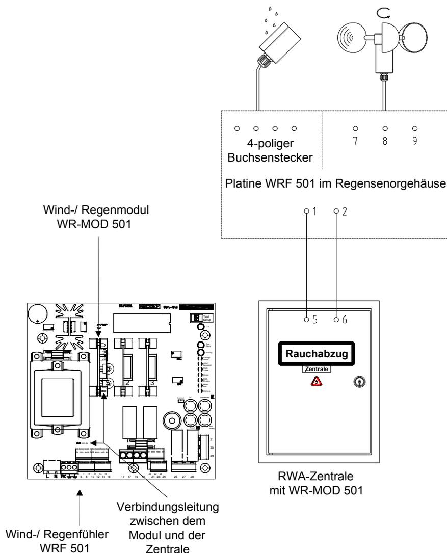
Abbildung 6: Anschluss Wind-/ Regenauswertung WRA 501
