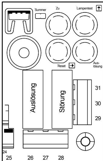
Das Störungsrelais (Klemme 29, 30, 31) dient der Störungsweitergabe. Das Auslöserelais (Klemme 26, 27, 28) dient der Auslöseweitergabe. Beide Relais (potentialfreie Wechslerkontakte) können bei 60V 3A schalten.
