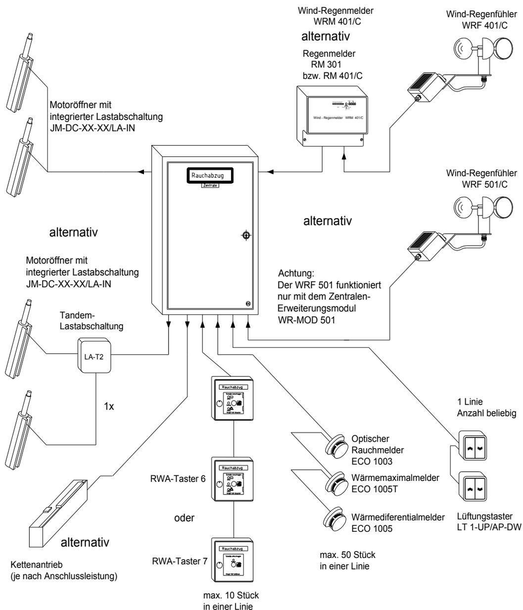
Abbildung 3: Übersichtsplan für Antriebe mit integrierter Lastabschaltung
