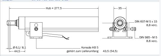
Bestellbezeichnung: JM - DC - T60 - 650 - Hub - M 8 Ø 6,1 oder Ø 8,1 (Aufnahmebohrung)
