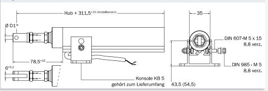
\* Die Aufnahmebohrung D1 kann zwischen Durchmesser 6,1 oder 8,1 gewählt werden.
