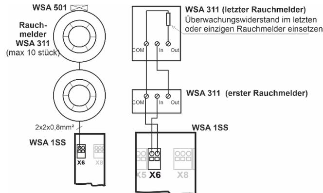
Wenn kein Rauchmelder an Klemme X6 angeschlossen ist, muss ein 10k $\Omega$  Widerstand an X6 angeschlossen werden.
