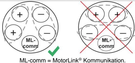
Außerdem muss bei Verwendung einer 5-adrigen Leitung der Abstand zwischen „-“ und „Com“ gleich dem Abstand zwischen „+“ und „Com“ sein.
