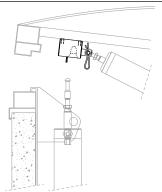
Sobald auf den Querbolzen im TS 5000 Druck ausgeübt wird, entriegelt das Traversenschloss automatisch den Entriegelungsbolzen.
