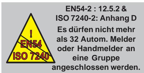
Bei der Installation müssen Handmelder und Automatische Melder auf getrennten Meldergruppen installiert werden. Dies ermöglicht auch eine verzögerte Ansteuerung bei Alarmen von Automatischen Meldern.
