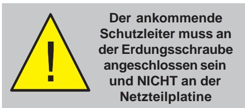
Die gesamte Verkabelung sollte den gültigen Richtlinien entsprechen. Beachten Sie außerdem die Anforderungen aus der EN54-14 bezüglich Verkabelung und Verbindungen von Brandmelde- und Alarmierungseinrichtungen.
