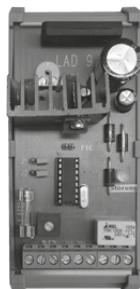
Erzeugt die Ladespannung für die Akkus und überwacht den Anschluss von Akku und Netz auf Unterbrechung, gemäß EN 12101-10.
