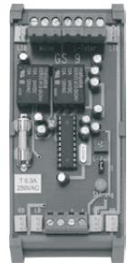
Dient zur Steuerung von Antrieben in einer Gruppe bis 8 A und zum Anschluss von Lüftungstastern. Die Antriebsleitungen sind überwacht gemäß prEN 12101-9. Used to control drives arranged in a group up to 8 A and to connect ventilation pushbuttons. The drive lines are monitored according to prEN 12101-9.
