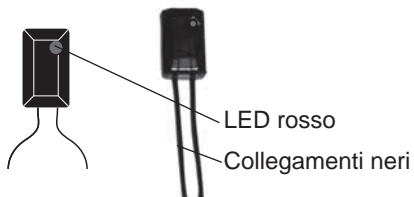
Modulo terminale attivo/2 (AE/2)
