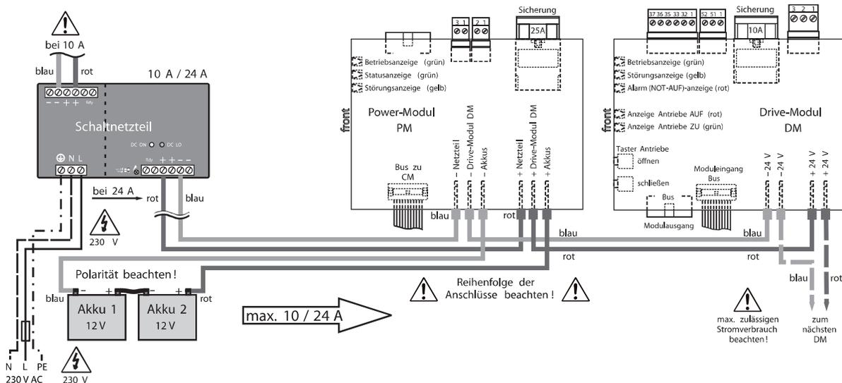
**Anschluss mit zwei Schaltnetzteilen**
