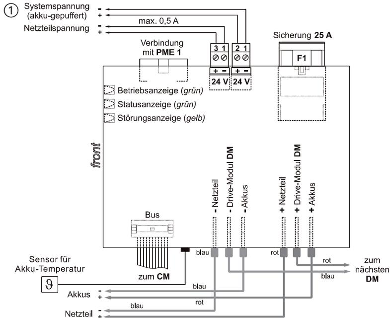
Bei Verwendung der akku-gepufferten Systemspannung (1) reduziert sich die Akku-Betriebsdauer und macht ggf. größere Akkus erforderlich.
