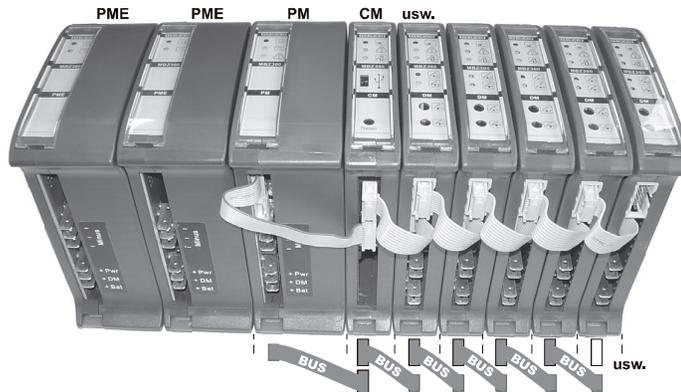
! Zwischen **PM**, **PME 1** und **PME 2** keine Verbindung unten. Nach **PM** folgt als nächstes Modul immer **CM**.
