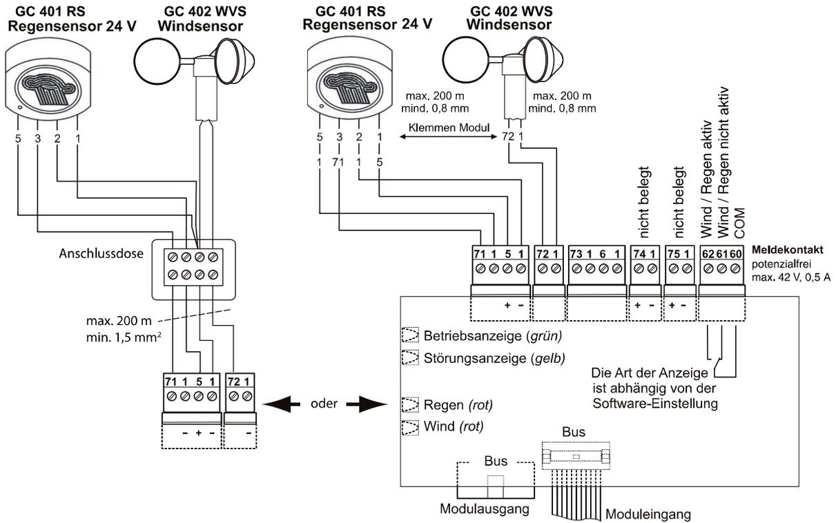
**Anschluss windrichtungsabhängiges Öffnen und Schließen**
