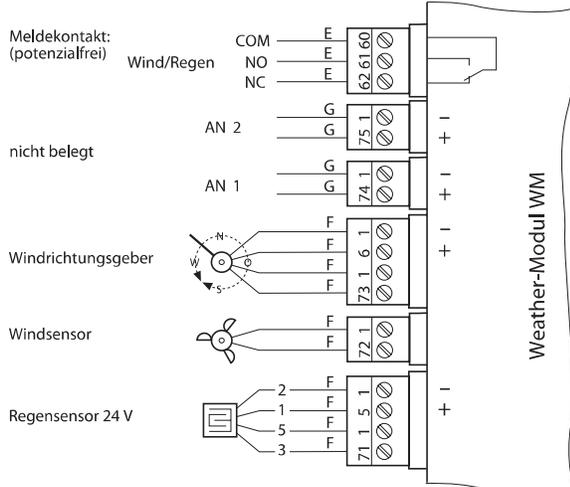
Wenn ein Windrichtungsgeber verwendet wird, müssen Wind- und ggf. Regensensor mit dem Anschluss des Windrichtungsgebers verschaltet werden (siehe Kap. 8.6).
