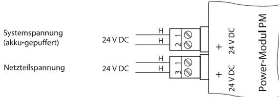
Der Strombedarf für akku-gepufferte Systemspannung (Power-Modul **PM**) reduziert die Akku-Betriebsdauer. Deshalb müssen ggf. größere Akkus verwendet werden.
