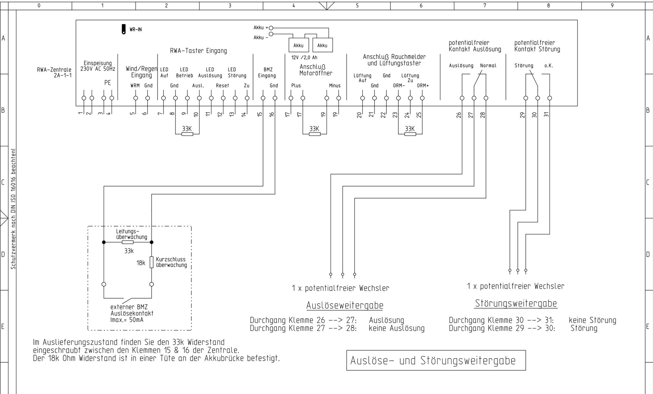
Im Auslieferungszustand finden Sie den 33k Widerstand eingeschraubt zwischen den Klemmen 15 & 16 der Zentrale. Der 18k Ohm Widerstand ist in einer Tüte an der Akkubrücke befestigt.
