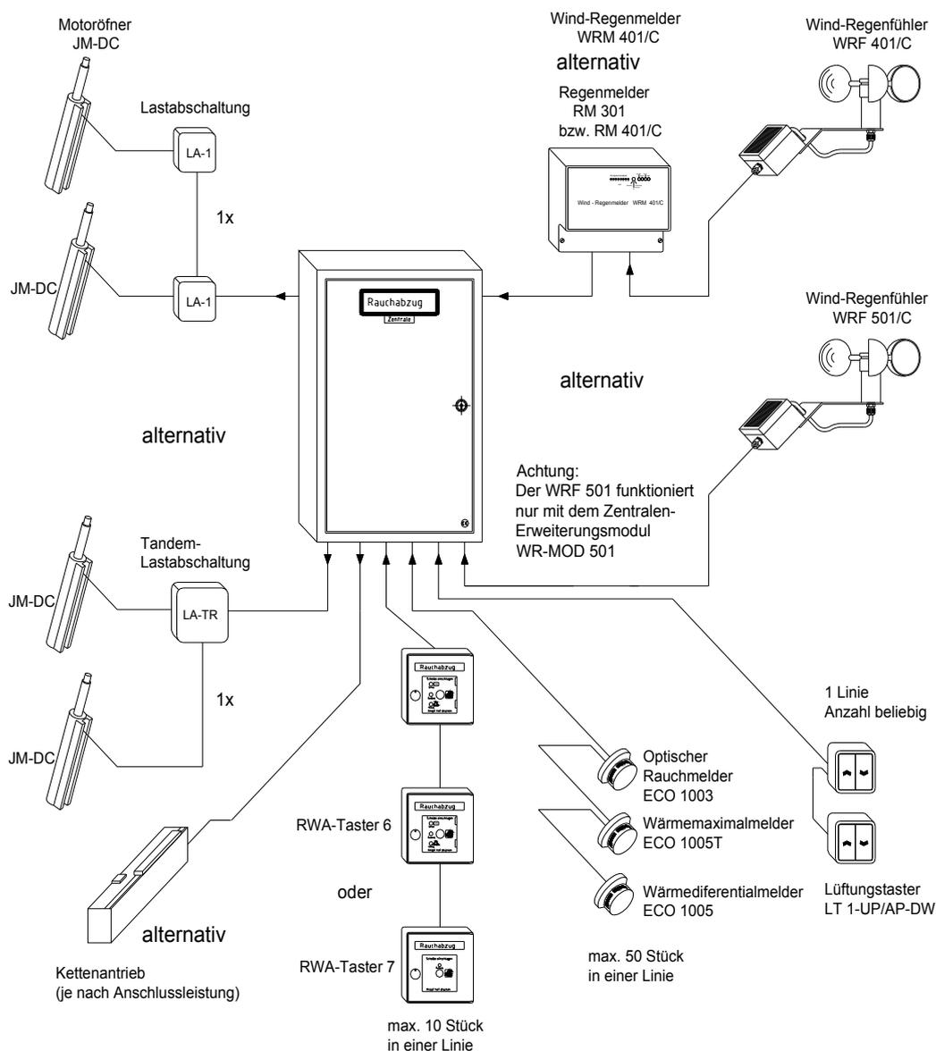
Abbildung 4: Übersichtsplan für Antriebe mit externer Lastabschaltung
